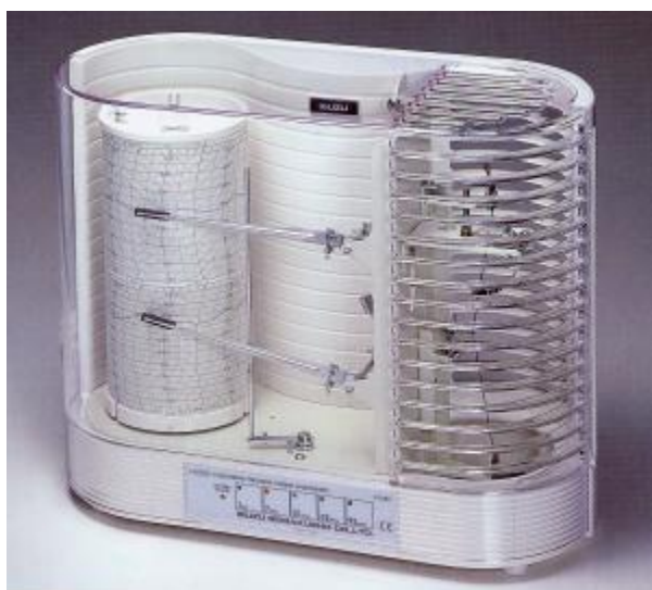
Slika 3-2. Primjer snimajućeg higrografa, ovdje u kombinaciji s istovremenim bilježenjem temperature (thermo-higrograf)
