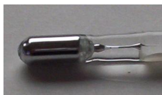
Slika 2-3. Posudica sa živom na vrhu termometra
