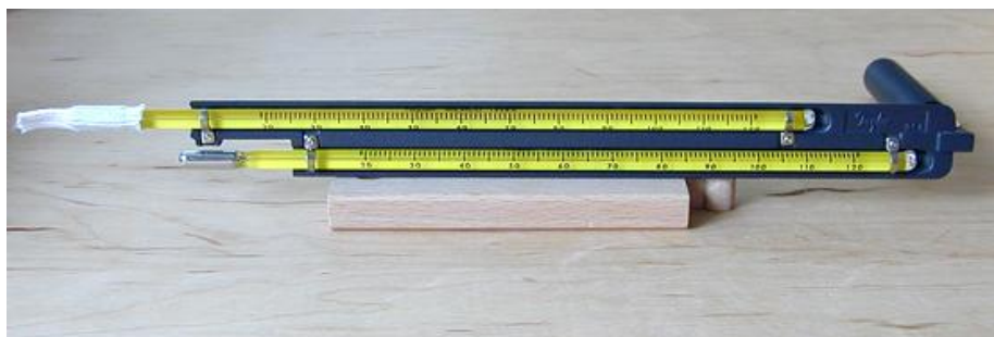
Slika 3-4. Obrtni psihrometar. Suhi i mokri (s krpicom) termometar su vidljivi
