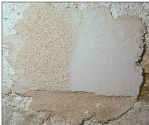
Slika 15.: Proba obrade žbuke za izvedbu žbukanih nadoknada u crkvi sv. Ivana Krstitelja u Šilovom selu (otok Šipan, Hrvatska) iz 2015. godine; lijevo – površina djelomično vlažne žbuke ostrugana Wishab spužvicom, desno – neobrađena površina, dolje – površinski sloj djelomično vlažne žbuke odstranjen metalnom pilicom.
