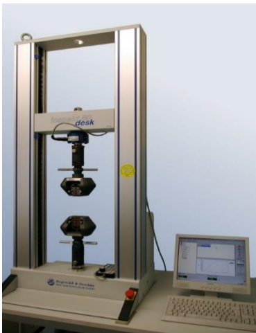
Slika 17. Kidalica- instrument za određivanje čvrstoće materijala.
