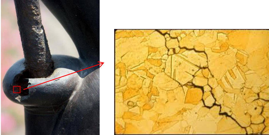
Slika 61. Transkristalna korozija uslijed statičkog naprezanja bronce.
