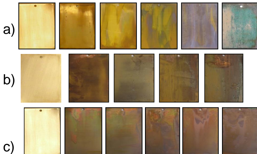
Slika 27. Formiranje korozivnih slojeva u a) gradskom, b) industrijskom i c) morskom korozivnom okolišu na uzorcima bronce CuSn6.
