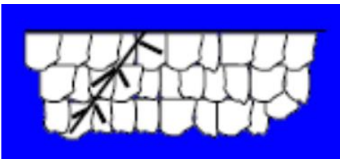
Slika 25. Shematski prikaz i SEM mikrofotografija transkristalne korozije
