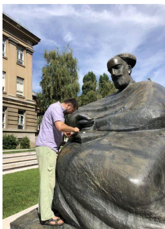
Slika 29. Impendancijska nedestruktivna mjerenja korozijskih oštećenja na skulpturama.
