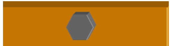
ČELIČNI VIJAK U BRONČANOJ KONSTRUKCIJI
