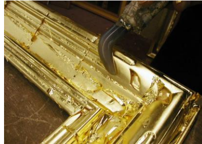
Slika 6. Poliranje ahatom nanesenih zlatnih listića na drveni okvir.
