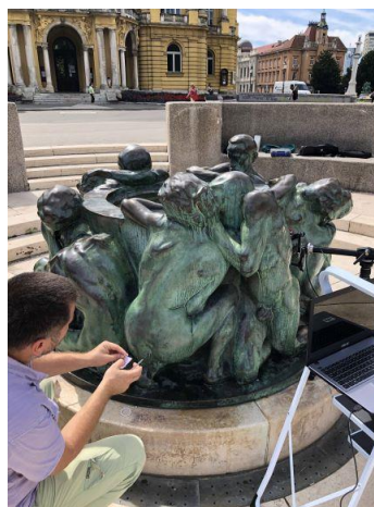
Slika 29. Impendancijska nedestruktivna mjerenja korozijskih oštećenja na skulpturama.
