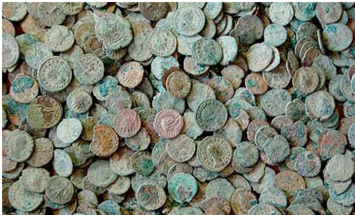
Slika 30. Tipičan izgled korozijskih produkata na bakru nastalih u tlu; zeleno-plavi slojevi malahita i azurita na tamno smeđem sloju kuprita. Vidljiv je i nastanak „raka bronce“.
