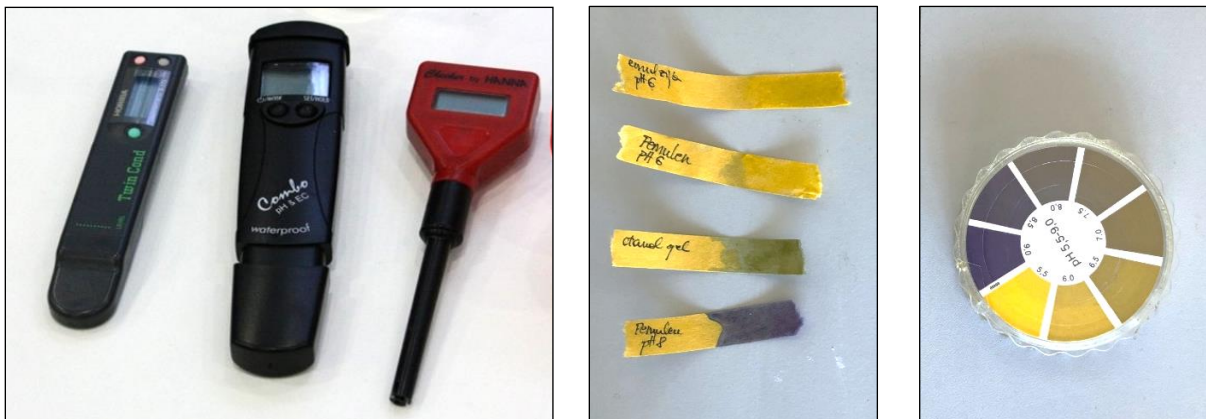
Slika 5.5. a, b i c Konduktometar, kombinirani uređaj za mjerenje pH i provodljivosti i pH metar (a); pH indikatorski papiri mijenjaju boju u kontaktu s otopinom (b) i uspoređuju se prema skali na pakiranju (c)
