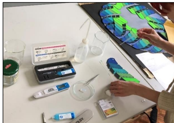
Slika 5.8. Priprema za mjerenje pH i provodljivosti površine
