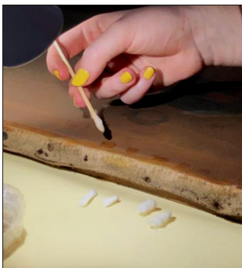
Slika 4.6. Test topivosti izveden uz rub slike
