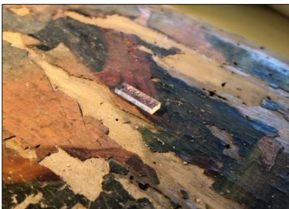
Slika 5.7. Mjerenje provodljivosti površine – komadić agar-agar gela za mjerenje provodljivosti površine
