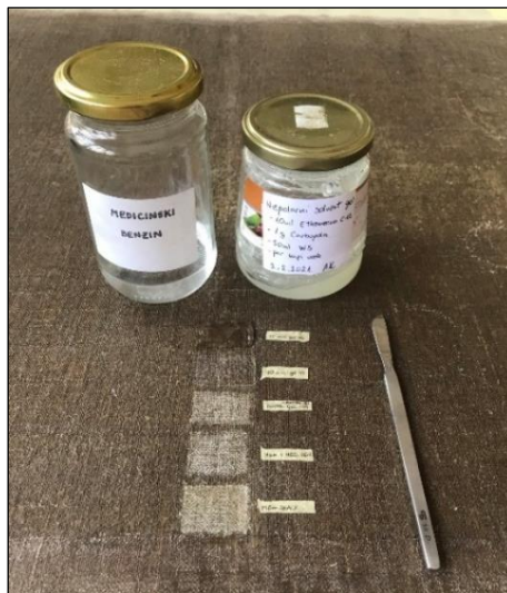
Slika 6.10. Probe uklanjanja voštane paste mehaničkim i kemijskim metodama na sekundarnom platnu
