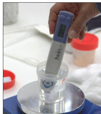
Slika 2.7. Mjerenje pH vrijednosti otopine za čišćenje
