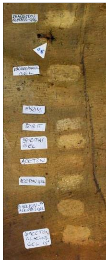
Slika 4.3. Probe čišćenja laka i površinske nečistoće
