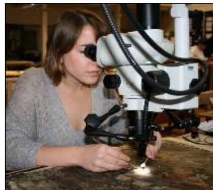
Slika 2.5. Primjena stereomikroskopa pri čišćenju
