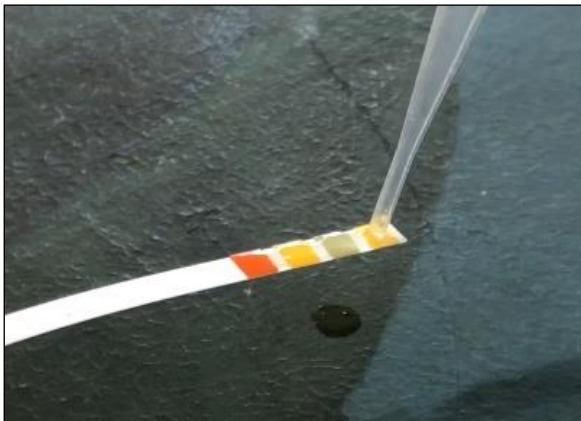
Slika 5.6. a, b, c i d Mjerenje pH površine slike kapljicom vode: kap vode ostavljena na površini slike 1 minutu (a); prijenos kapi vode pipetom (b) na pH indikatorsku trakicu (c) i očitavanje rezultata na skali (d)
