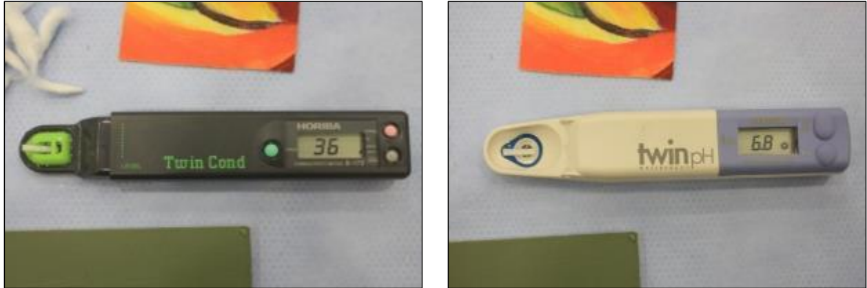
Slika 5.4. a i b Konduktometar – mjerenje provodljivosti površine (a); pH metar – mjerenje pH površine mokrom bugaćicom (b)
