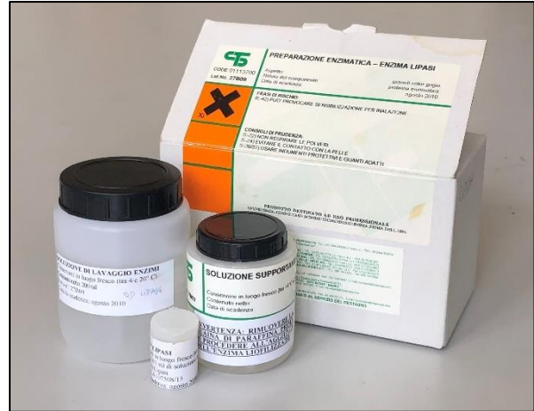
Slika 5.21. Komercijalni enzimi tvrtke C.T.S., s dehidriranim enzimima u prahu, otopinom za enzime i otopinom za ispiranje
